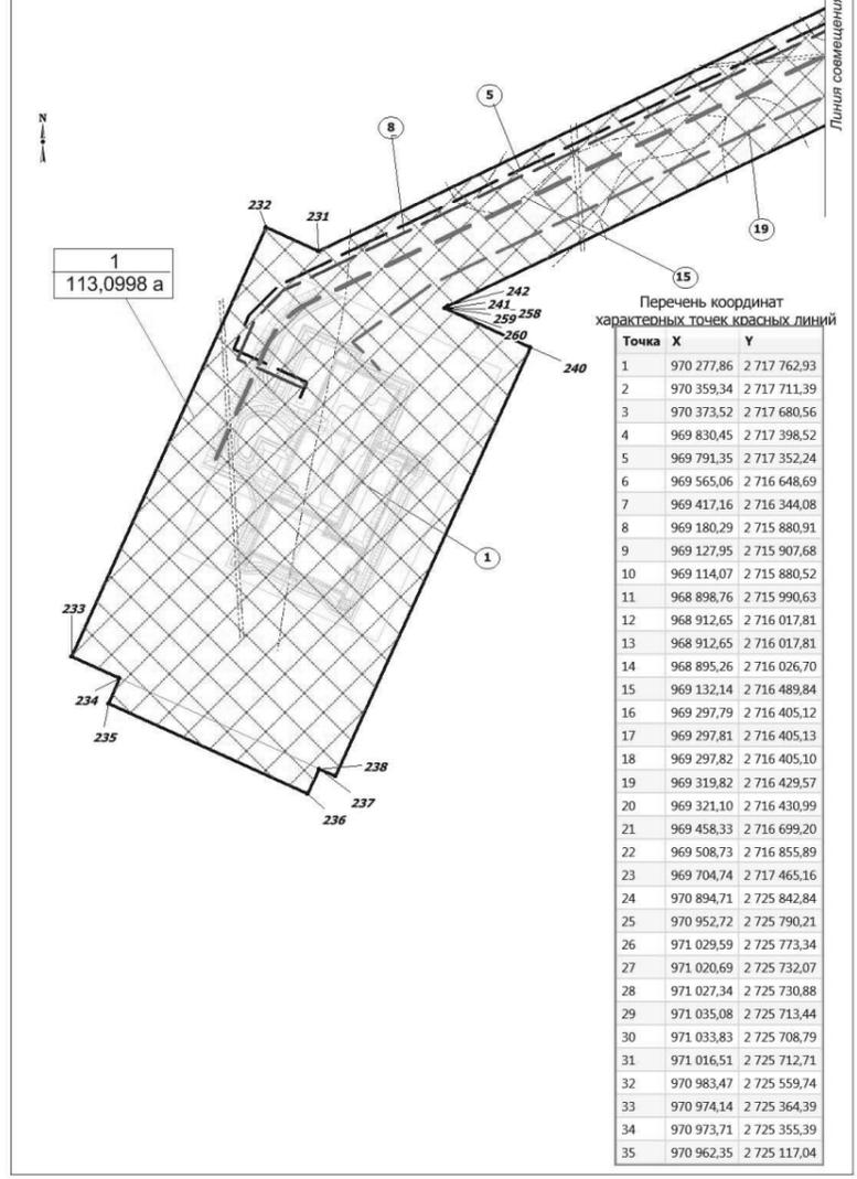
Чертеж красных линий, границ зон планируемого размещения линейных объектов
